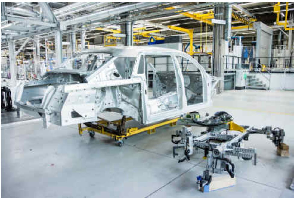
Die Karosserie aus Aluminium in Space-Frame-Bauweise wird von Hand zusammenschweißt und dann gut verpackt nach Goodwood in England geliefert, wo sie lackiert wird. Foto: obx-news/Rolls-Royce Motor Cars
